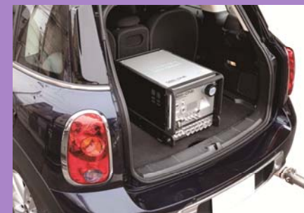
車載型排ガス測定装置
