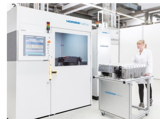
燃料電池システム評価
