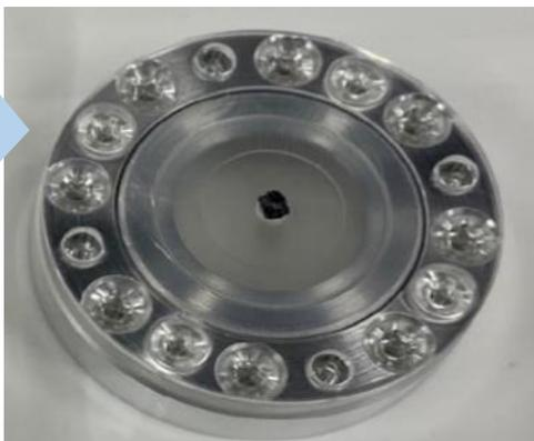
高度なサンプルハンドリングを可能にする、リュウグウの試料専用の容器（セル）も開発
