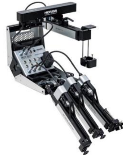
「ADS EVO」 シャシダイナモ上で 車両運転を行うロボット。 RDE再現試験などに使用
