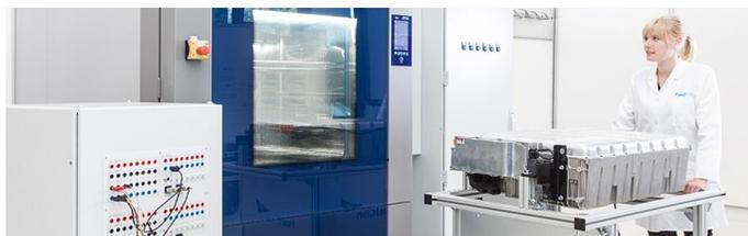
バッテリーモジュール・パック試験システム
