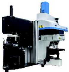
ラマン分光分析装置 (次世代半導体材料の評価)
