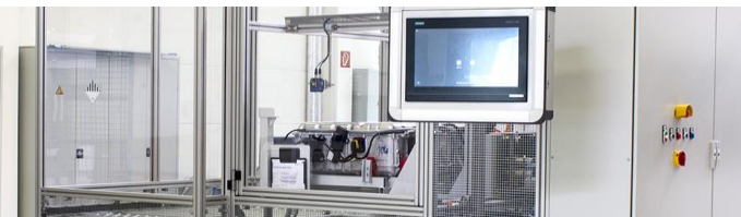
バッテリー生産ライン試験システム
