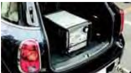
車載型 排ガス測定 システム 「OBS-ONE」
