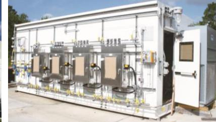
\*分析計、サンプリング装置を組み込んだシェルター。各プロセスにおける計測機器をシステム化し、お客様に一括で提供
