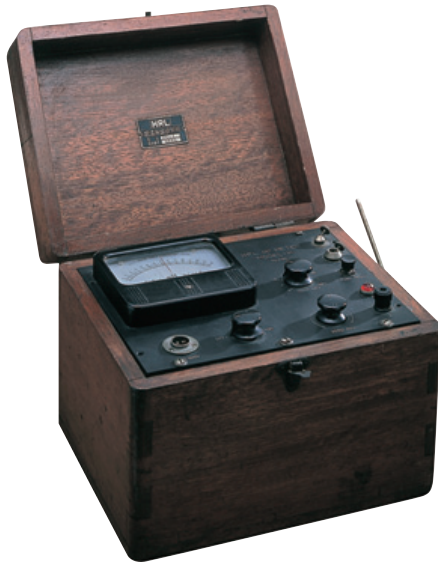
Figure 2 ガラス電極式pH計 H型(1951年製)
