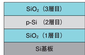
光学モデル (実際のサンプル構造も同じ)
