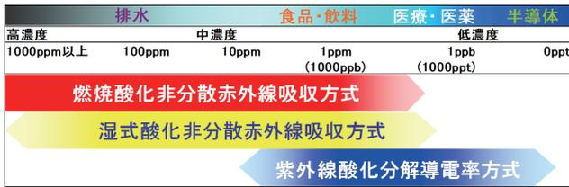
Figure 3 TOCの測定原理と測定レンジ
