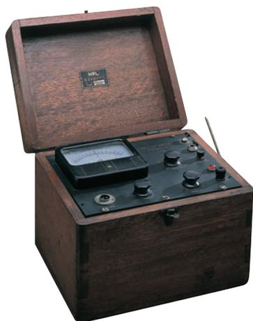
Figure 1 国産初のガラス電極式pHメータ
