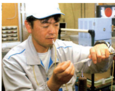
Figure 12 熟練ガラス加工者によるpH電極の加工風景
