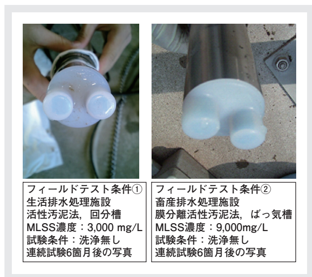
図11 MLSSセンサ汚れの状態
