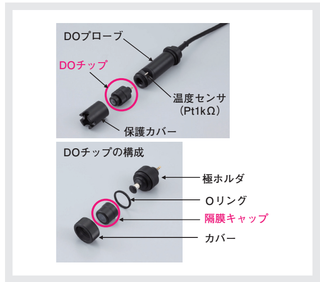
図9 DOプローブ(DO-1100), DOチップ(5505)の構造図
