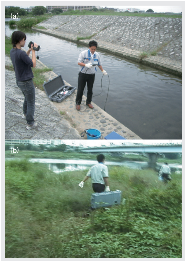
図4 現場での観察風景 (a)長いセンサーケーブルの扱いやすさは？ (b)草むらでキャスターは役に立たない
