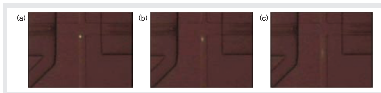
図2 細胞の捕捉と溶解、それに続く溶解物の分離チャンネルへの迅速注入
