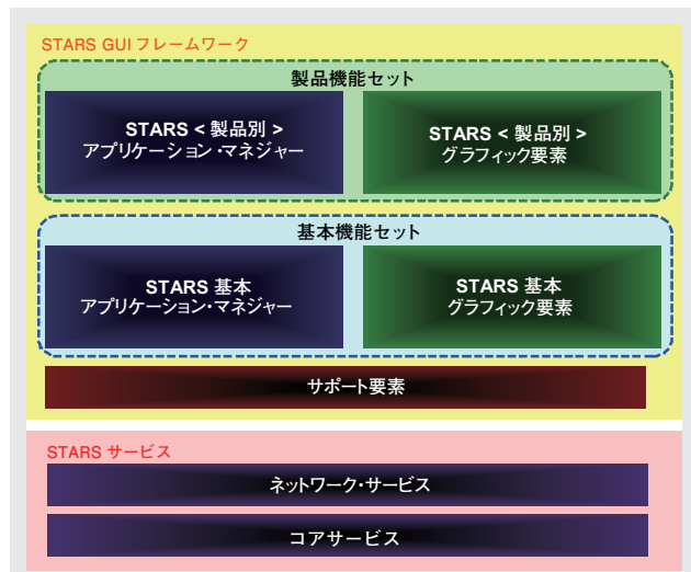
図2 アプリケーション機能セットによるSTARSプラットフォーム基本機能の拡張・カスタマイズ
