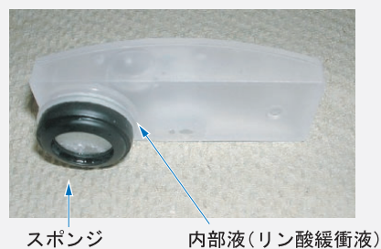
(a) バッファタンクの外観
