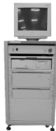
図1 VSET-1000 コントロールラック
