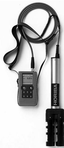
図1 マルチ水質モニタリングシステムU-23
