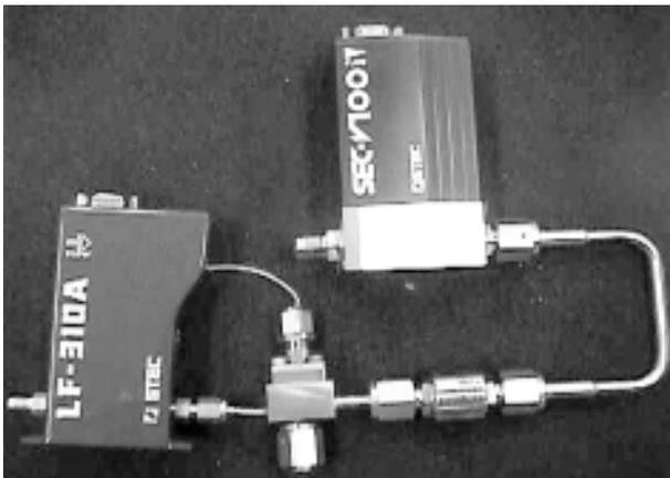
図1 試作した気液混合型の気化器
