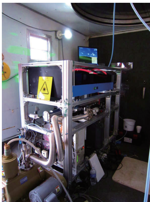
図3 (左)開発したOHラジカル反応性測定装置の写真、(右)コロラド州マニトウ国立森林研究センター内での観測風景(2010年8月実施)
