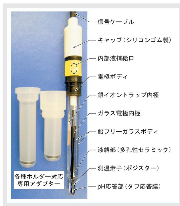
図4 鉛フリーpH電極の構成例
