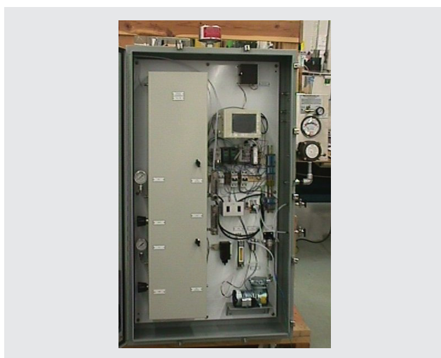
図5 試料凝縮防止用外部加熱測定セル及び硫黄化合物検出感度向上用オプションポンプが付いた内部構造
