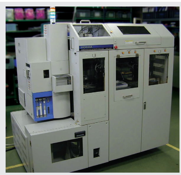
図1 全自動炭素 / 硫黄分析装置EMIA-Vシリーズの外観
