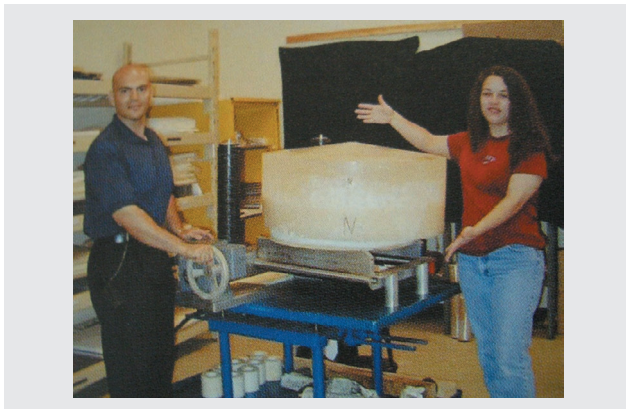
図1 直径31インチ・重量500 kgのヨウ化ナトリウム結晶
