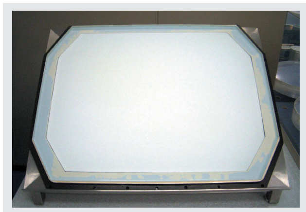
図8 ガンマプレートの例(480 mm × 550 mm)
