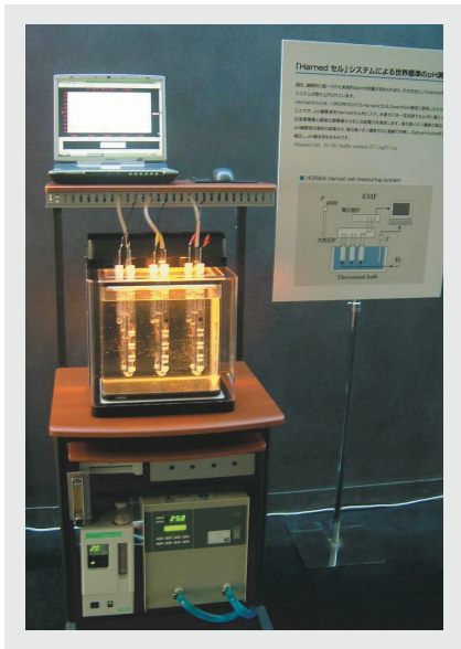
図2 Harnedセル(本賞審査委員 独立行政法人産業技術総合研究所 中村 進主任研究員の指導による。)
