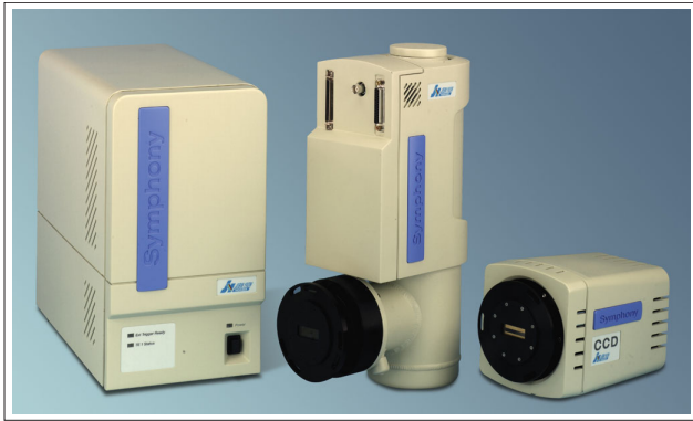
図1 CCD検出器Symphonyシリーズ Symphonyコントローラ, 液体窒素ヘッド, 電子冷却CCDを含む。
