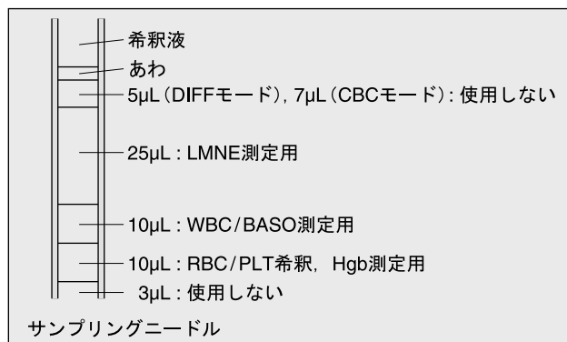
図6 PENTRA60 < LC-5000 > のサンプル吸引量と用途
