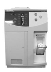
炎症疾患,感染症の早期診断・経過観察に有効な指標である白血球数とCRPの測定は,従来別々の装置で行っていました。LC-175CRPは,血球計数用の1容器(EDTA入り)だけでこれら両方の測定を可能(世界初)にしました。測定項目は,CRP定量測定と血球計数の基本8項目と白血球3分類になっています。
