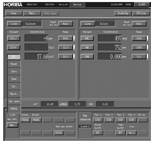
図1 MEXA-7000 のアラーム発生表示画面 Warning screen on the MEXA-7000
