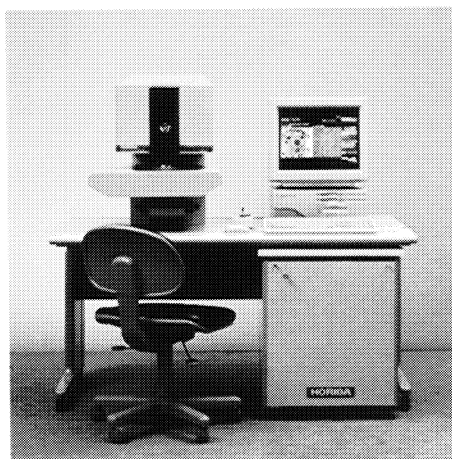
図10 試作した卓上型X線分析顕微鏡 Test-produced desktop X-ray analytical microscope
