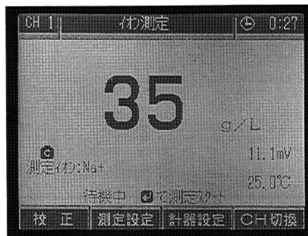
図5 イオン濃度の測定 Measurement of ion concentration
