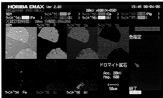
図11 ドロマイト鉱石の面分析例 Example of face analysis of dolomite ore
