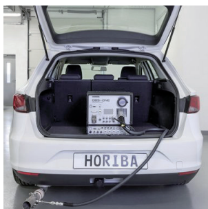
Figure 2 受賞した開発技術を用いた車載型排ガス計測システム「OBS-ONE」②
