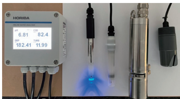
Figure 8 多項目変換機に接続されたセルフクリーニング pH(左)、ORP(左中)、CODuv(右中)、濁度(右)
