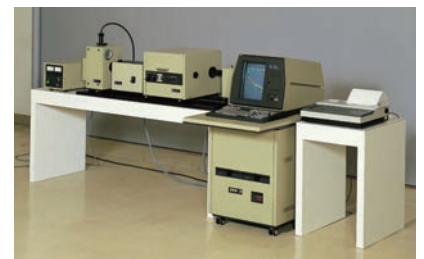
Figure 2 1983年 NAES-1100販売開始 時間相関単一光子計数法を用いた蛍 光寿命測定装置
