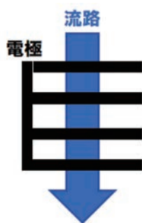
Figure 4 本発明におけるLED電極のくし部分とフローセルの流路との関係図
