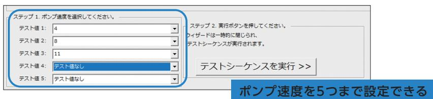
Figure 4 循環ポンプ速度設定画面の例
