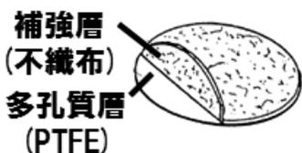
Figure 3 本発明の特徴部分であるフィルタ構造
