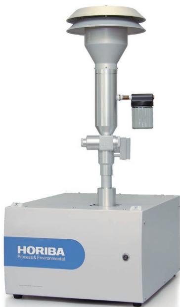
Figure 2 PM2.5 濃度測定及び成分分析装置(PX-375)
