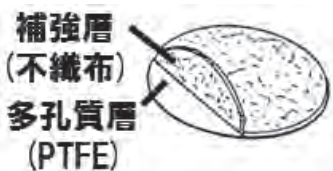
Figure 3 本発明の特徴部分であるフィルタ構造
