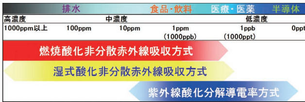
Figure 3 TOCの測定原理と測定レンジ
