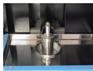
燃焼ダスト排出部
