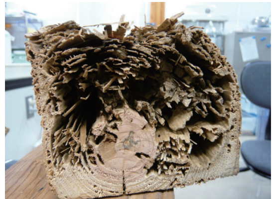
Figure 2 シロアリに食害された木材の断面 年輪沿いに、柔らかい場所から食害される。
