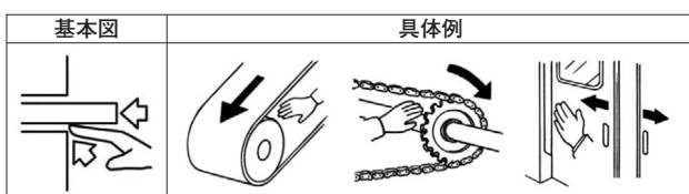
Figure 2 機械的危険源の例 (引用：厚生労働省安全情報「危険源の参考図：機械的危険源の具体例の図」 [2] )
