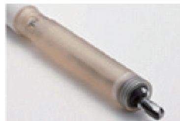
Figure 15 耐フッ酸pH電極
