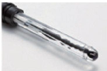
Figure 14 ドーム型タフpH電極 (一体型複合電極 6108-50B)
