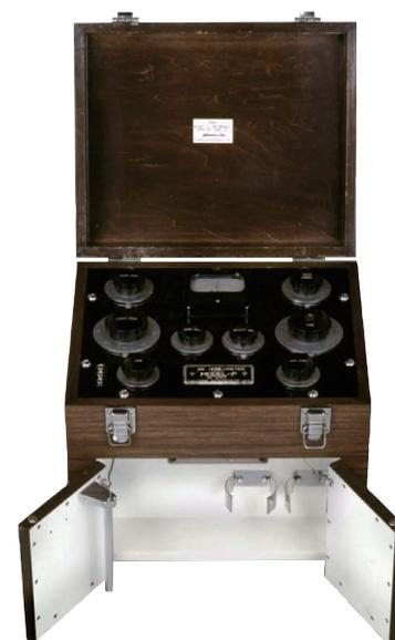
図1 P型pH計(復元モデル)
