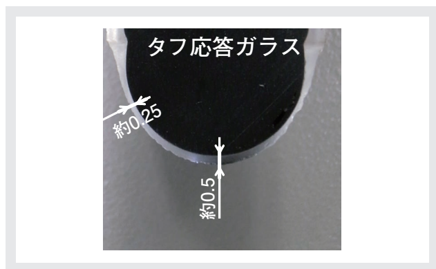
図6 ドーム形pH電極(6108-50B)応答ガラス部分の断面図
