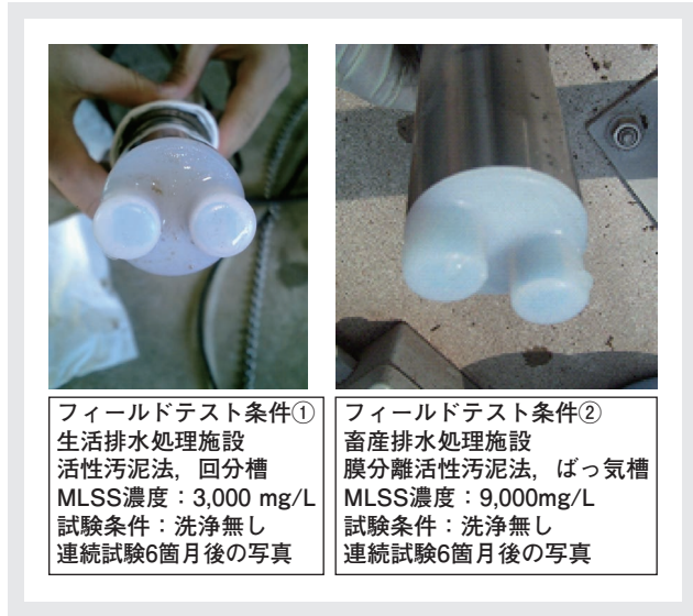
図11 MLSSセンサ汚れの状態
