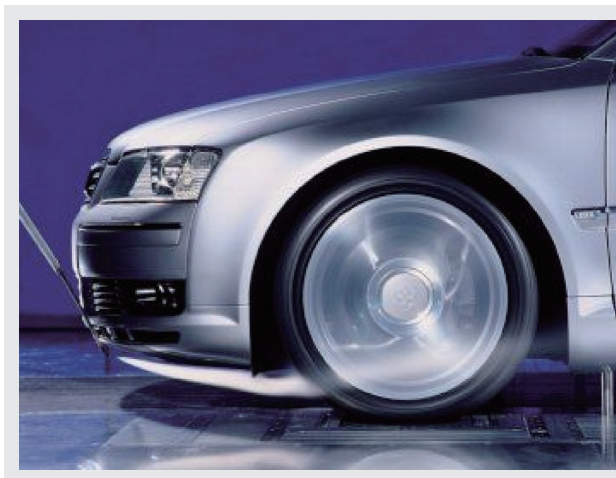
図6 ホイールスピナによる車輪の回転
