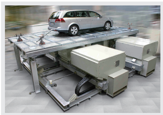
図2 4WDインライン型NVH用シャシダイナモメータ
