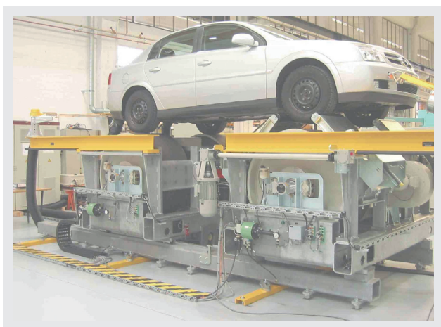
図1 四輪駆動(4WD)センターマウント型シャシダイナモメータ
