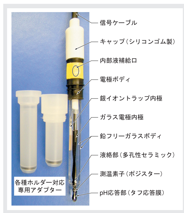
図4 鉛フリーpH電極の構成例
