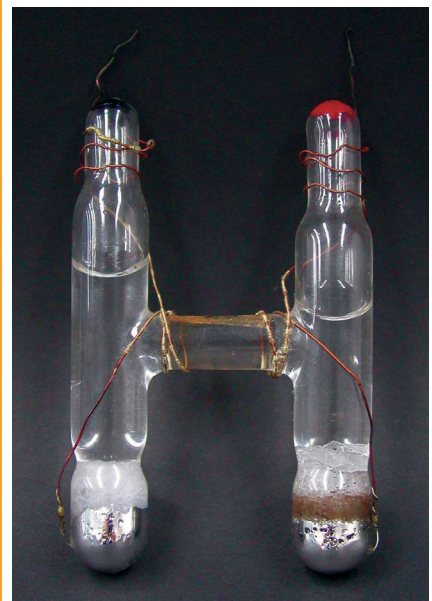
図2 カドミウム標準電池(独立行政法人産業技術総合研究所(AIST)ご提供)
